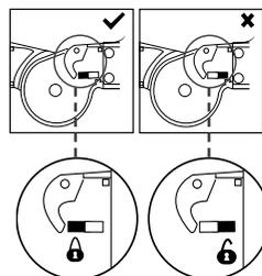
1. - Pour déverrouiller les charnières, tirer sur le levier de chaque charnière jusqu'à ce que la languette de verrouillage soit en position déverrouillée.
