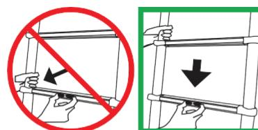
**14** Repliez les deux montants supérieurs en appuyant sur les deux boutons.
