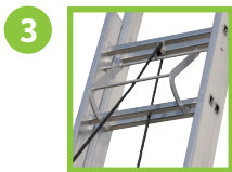
PARACHUTE ACIER DOUBLE BRAS Il s'ouvre en tirant sur la corde et se bloque simplement par gravité. Il permet un réglage de la longueur barreau par barreau.
