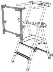
2. Retirer le pantographe
